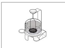
可读性为0.1 mg/1 mg的高级和标准天平型号的密度测定组件
