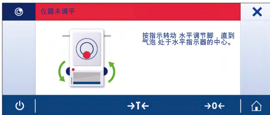
执行指令后，水平调节助手将继续执行下一步骤。按照步骤进行操作，直至调平天平。
