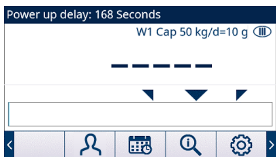
Fig. 54: Retraso de encendido mostrado en la línea del sistema
