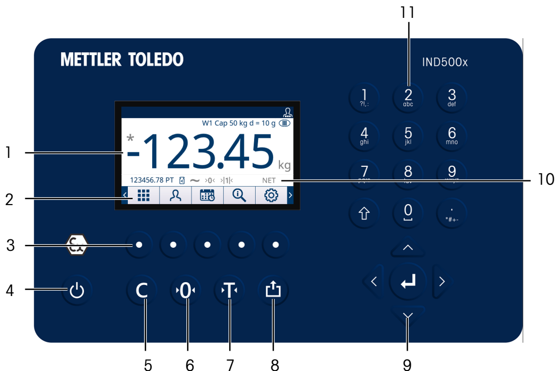
Fig. 9: Pantalla de visualización y ubicación de las teclas
