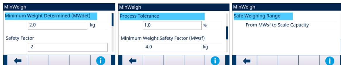
Fig. 56: Configuración de Peso mínimo
