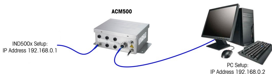
Fig. 132: Ejemplo: Configuración de la dirección IP (cruzada o con concentrador)
