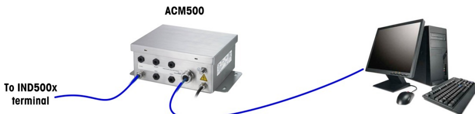
Fig. 130: Conexión con cable cruzado
