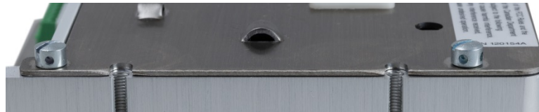
Figure 2-127 : Vis d'apposition des sceaux installées
