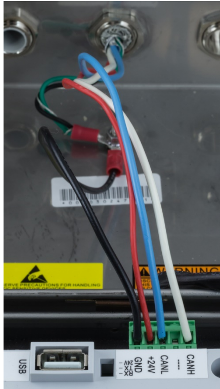
Abbildung 2-58: Im Terminal angeschlossene POWERCELL-Adern
