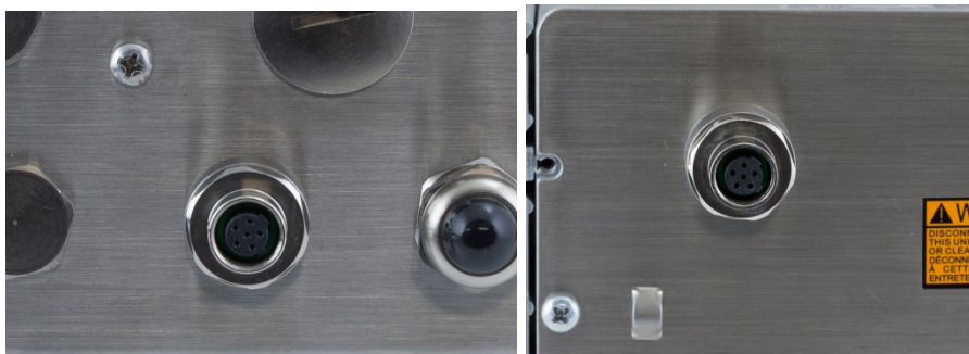
Figure 2-34 : Emplacement du connecteur SICSprö sur les enceintes pour environnement difficile (à gauche) et sur les enceintes pour montage sur panneau (à droite)
