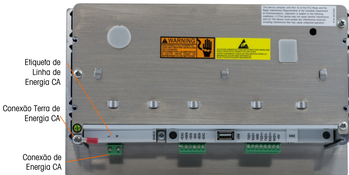
Figura 2-29: Conexão de Energia CA na Montagem do Painel
