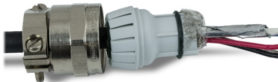
Figure 2-71 : Blindage intérieur non tressé et rabattu par-dessus le passe-câble
