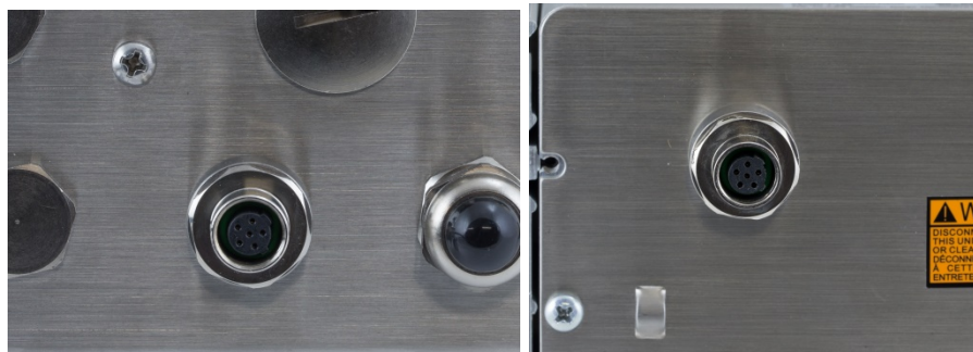
Figura 2-34: A Localização do Conector SICSPRO nos Gabinetes para ambiente adverso (esquerda) e com Painel (direita)
