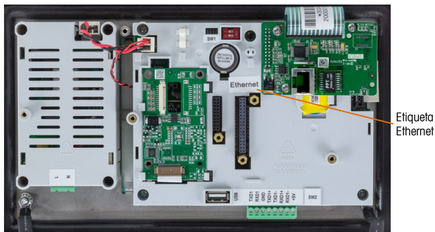
Figura 2-96: Opção Ethernet Instalada na Placa Principal
