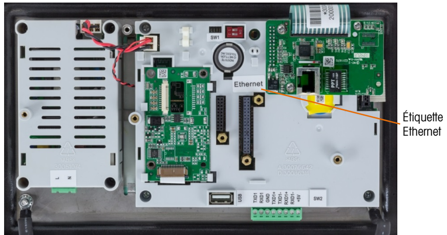
Figure 2-96 : Option Ethernet installée sur la carte principale
