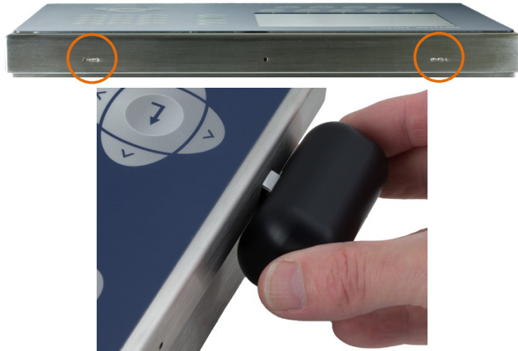
Abbildung 2-2: Gehäuse für raue Umgebungen öffnen, bevorzugte Methode
