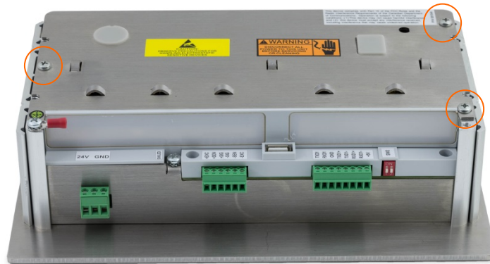
Abbildung 2-1: Öffnen des Gehäuses für Schaltschrankeinbau
