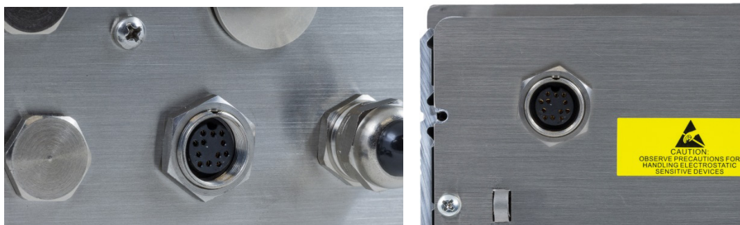
Figura 2-32: Ubicación del conector IDNet en las cajas para ambientes adversos (izquierda) y montaje en panel (derecha)
