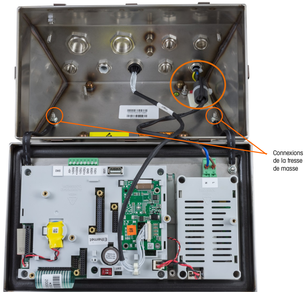
Figure 2-14 : Desserrage des tresses de masse
