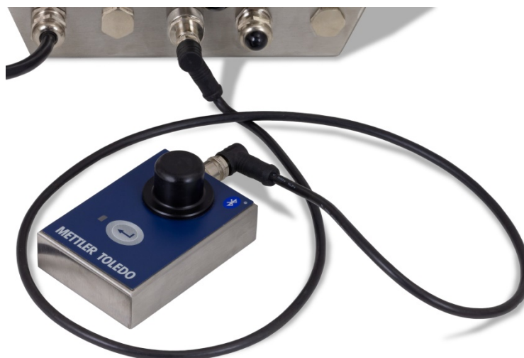
Figure 2-35: Module Bluetooth connecté à l'IND570
