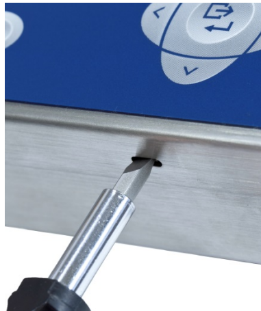
Figure 2-4 : Ouverture de l'enceinte pour environnement difficile
