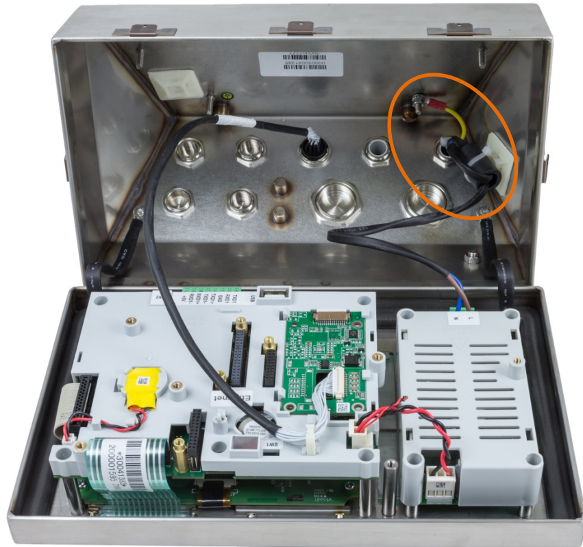
Figura 2-17: Pannello anteriore e connessione della cella di carico invertiti
