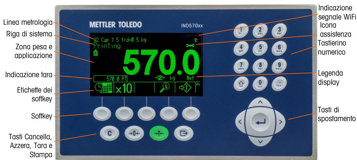
Figura 1-10: Layout del pannello anteriore dell'IND570
