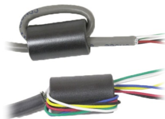
Figura 2-20: Installazione dei nuclei in ferrite
