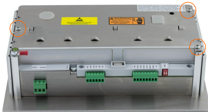
Figura 2-1: Apertura dell'involucro di montaggio a pannello
