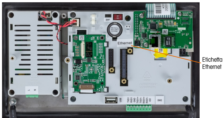
Figura 2-96: Opzione Ethernet installata sulla scheda principale
