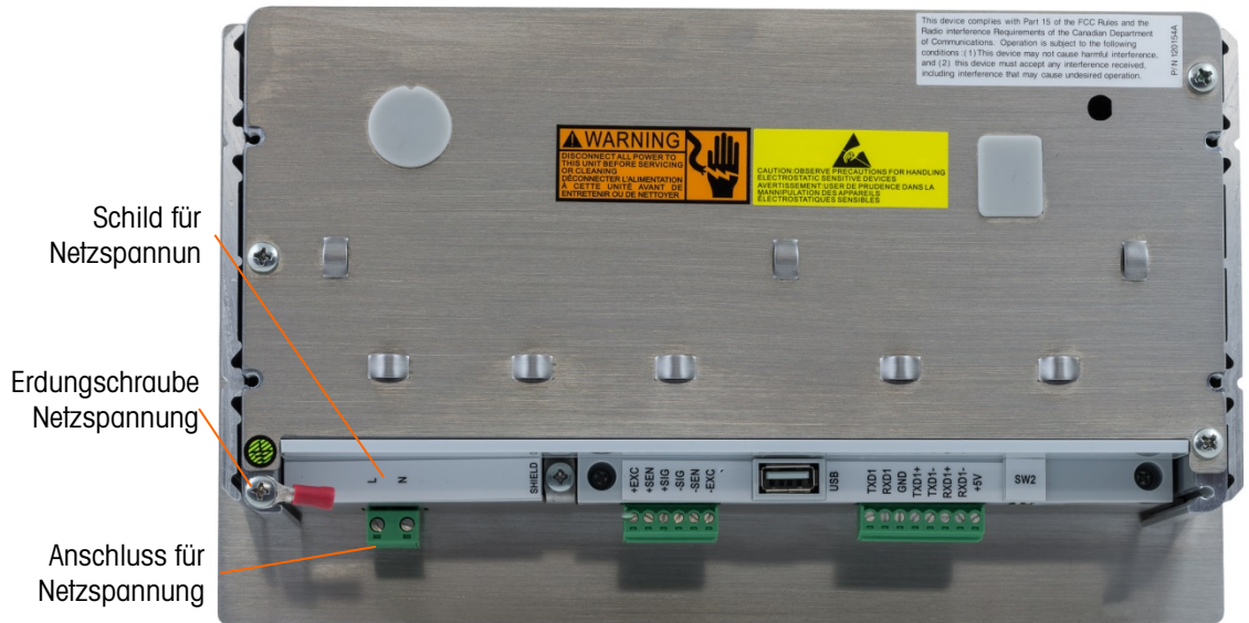
Abbildung 2-27: Netzspannungsanschluss an dem Modell für Schaltschrankbau
