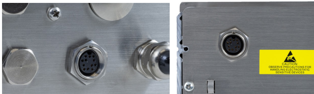
Abbildung 2-30: Lage des IDNet-Verbinders an dem Gehäuse für raue Umgebungen (links) und Frontplattengehäuse (rechts)
