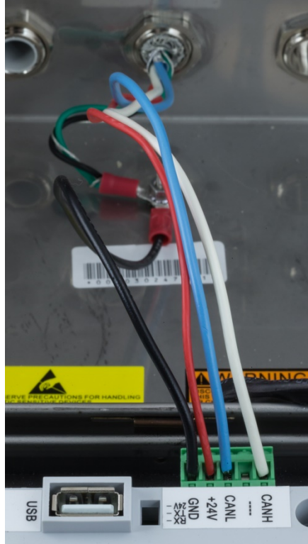
Figura 2-60: Alambres POWERCELL conectados en terminal
