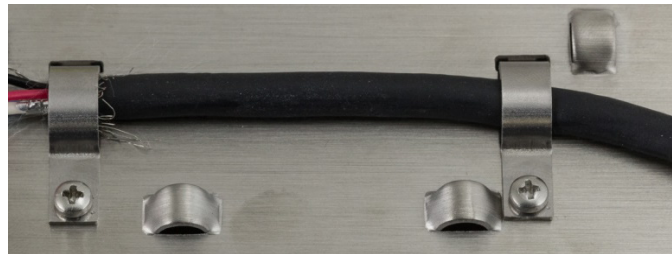
Figura 2-85: Cabo PowerMount Fixado
