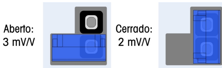
Figura 2-122: Posiciones de la conexión en puente de milivoltios W1
