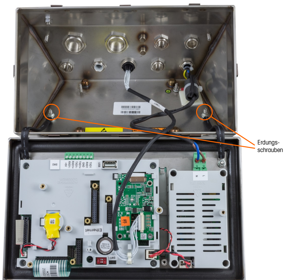
Abbildung 2-13: Lösen der Erdungsbänder
