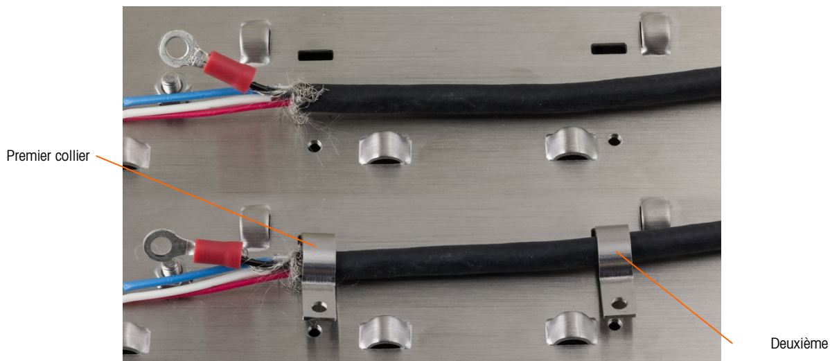
Figure 2-84 : Sécurisation du câble PowerMount – panneau
