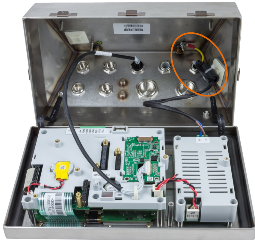
Figura 2-17: Painel Frontal e Conexão de Célula de Carga Revertidas
