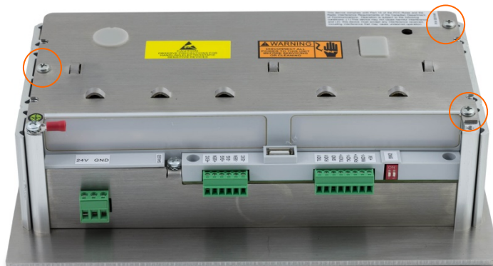
Figura 2-1: Abertura do Gabinete Montado em Painel
