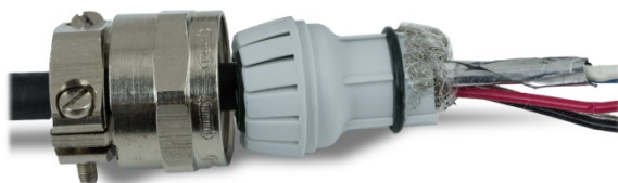
Figura 2-71: Blindaje interno separado y plegado sobre la arandela de plástico
