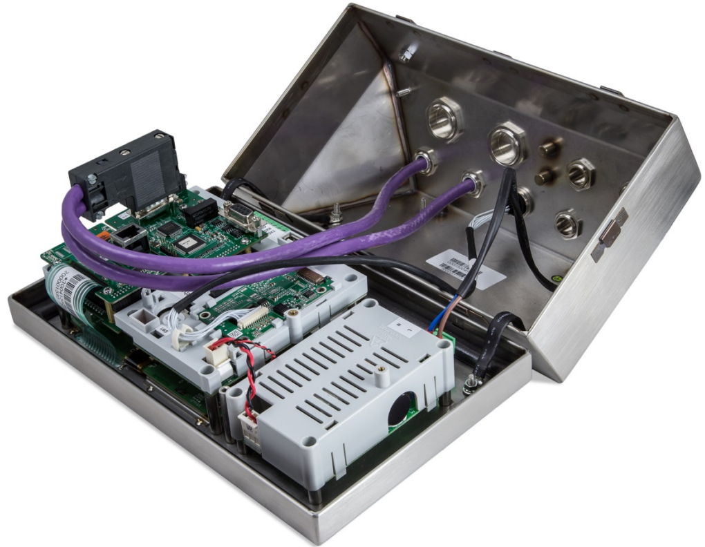
Figura 2-116: Conexão de Cabo PROFIBUS em Gabinete para Ambiente Adverso
