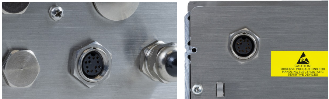
Figure 2-32 : Emplacement du connecteur IDNet sur les enceintes pour environnement difficile (à gauche) et sur les enceintes pour montage sur panneau (à droite).
