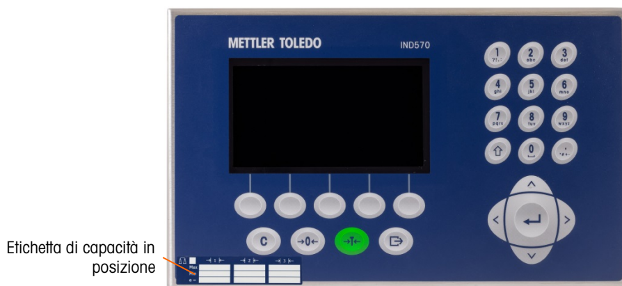
Figura 2-125: Etichetta di capacità installata
