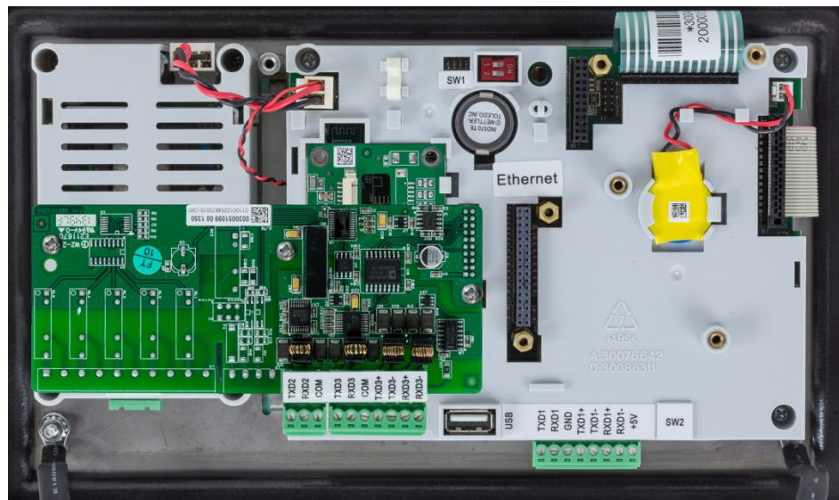
Figura 2-99: Tarjeta opcional COM2/3 instalada
