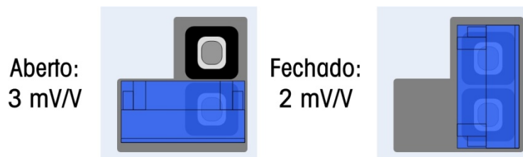
Figura 2-122: Posições de Jumper de Milivolt no W1
