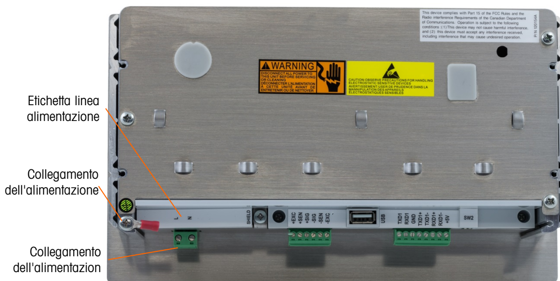
Figura 2-29: Collegamento dell'alimentazione in CA al montaggio a pannello
