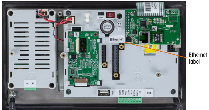
Abbildung 2-94: Ethernet-Optionsplatine auf der Hauptplatine
