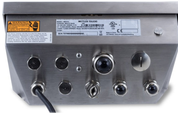
Abbildung 2-64: IND570-Gehäuse für raue Umgebungen mit Kabeldurchführung für PowerMount-Anschluss
