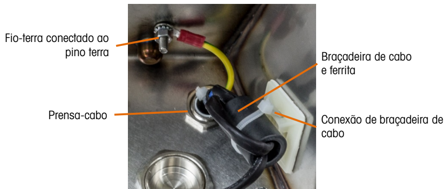
Figura 2-16: Localização reversa do cabo de energia
