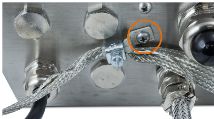
Abbildung 2-54: Am Gehäuse befestigte Erdungsklemme
