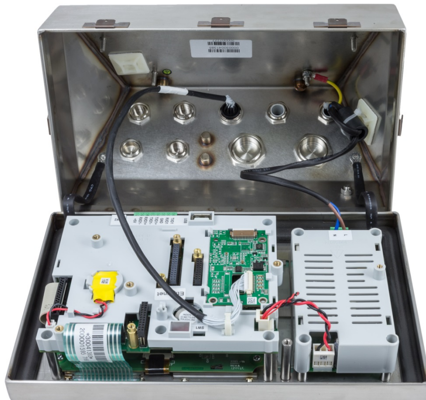
Abbildung 2-15: Frontplatte und Anschluss der Wägezelle von hinten
