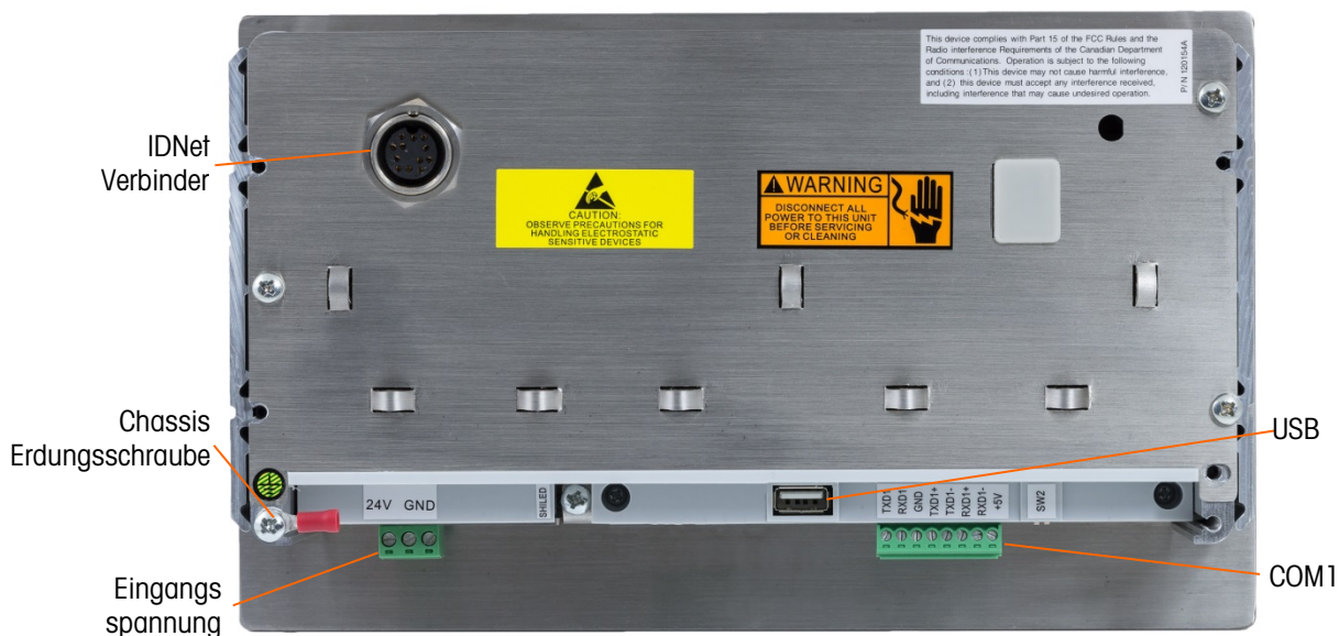
Abbildung 2-25: Anschlüsse im Gehäuse für Schaltschrankeinbau mit IDNet-Waagenschnittstelle
