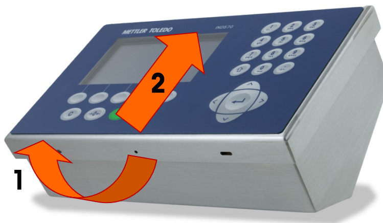
Figura 2-5: Retiro de la cubierta
