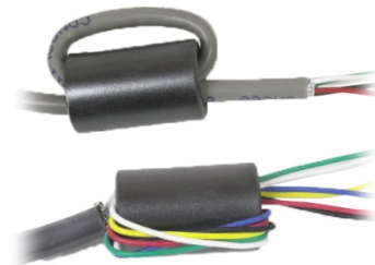
Abbildung 2-18: Einbau der Ferritperlen.
