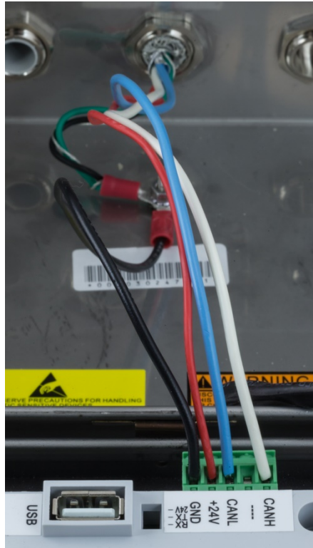
Figura 2-60: Fios POWERCELL Conectados no Terminal
