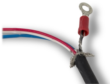
Figura 2-81: Terminal de Anel Crimpado em Fios Preto e de Drenagem
