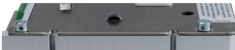
Figura 2-127: Parafusos de Lacre Instalados
