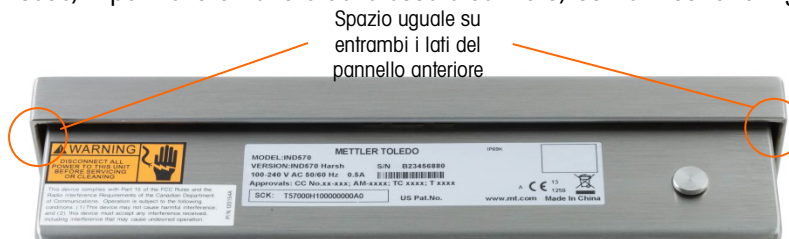
Figura 2-6: Pannello frontale dell'armadietto per ambienti difficili correttamente allineato
