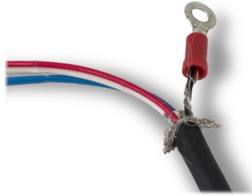
Abbildung 2-79: An schwarzer Ader und Beilaufdraht angebrachter Kabelschuh
