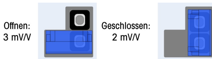
Abbildung 2-120: Positionen der Millivolt-Drahtbrücke W1
