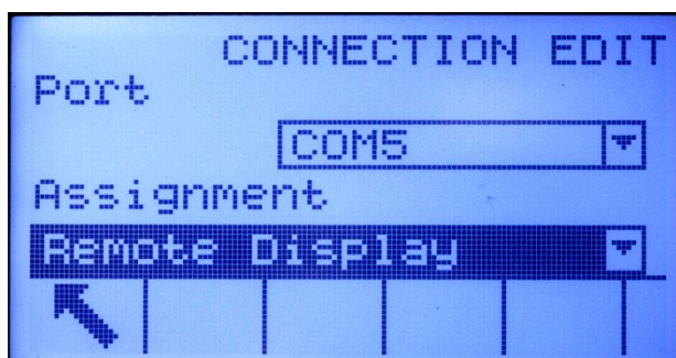
Figure 3-15: Connexion COM4/COM5 configurée pour une opération distante
