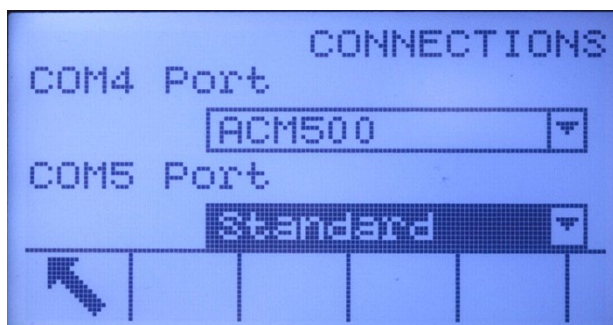
Figure 3-14: Connexion COM4 ou COM5 configurée pour convertisseur à fibres optiques ou ACM200
