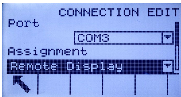
Figure 3-13: Connexion COM2/COM3 configurée pour une opération distante
