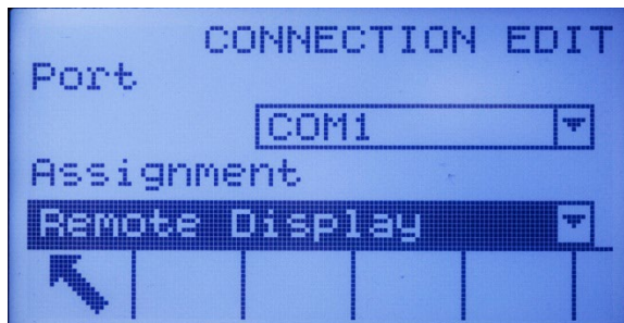
Figure 3-11: Connexion COM1 configurée pour une opération distante
