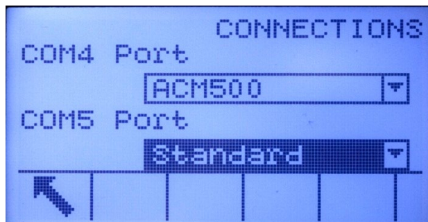
Figure 3-12: Connexion COM4 configurée pour l'ACM500
